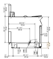
Electrical inlet (power) EQ Equipotential screw
